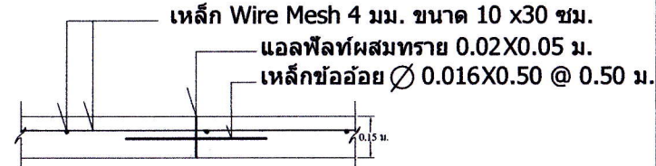
แบบขยาย LONGITUDINAL JOINT 1 : 25
